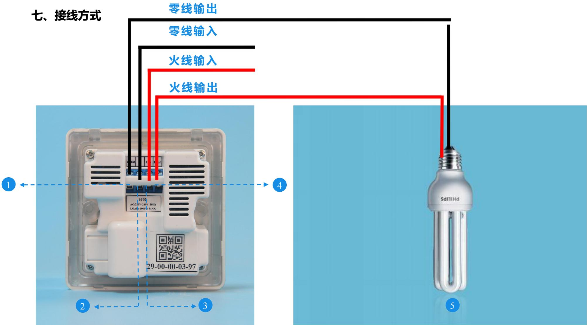
标注：① COM：零线输出接口 ② N：零线输入接口 ③ Lin：火线输入接口 ④ Lout：火线输出接口 ⑤ 负载（灯具）
